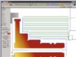
Ebauche longitudinale (Pas d'ajout de géométrie pour éviter les gorges)
