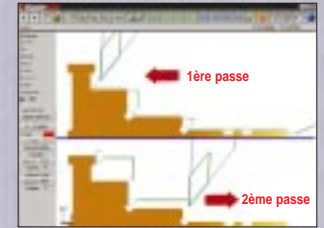
Contournage de finition en 2 cycles
